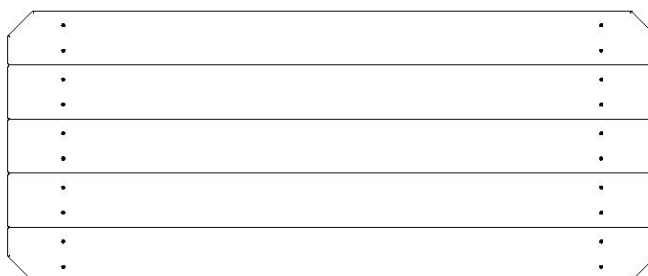
TP1 | PLATEAU DE TABLE DE PIQUE-NIQUE - W2A03413 (x1) | 1 7/8 po x 16 15/16 po x 40 11/16 po (48 x 430 x 1034)
